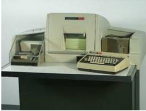
Figura 4: Perforada de tarjetas, de las que se llegaron a disponer tres en nuestro Centro de Cálculo. Toda la información de entrada al computador (programas y datos) se daba mediante tarjetas perforadas. Por ejemplo, todos los datos de los alumnos había que introducirlos por medio de tarjetas perforadas.
