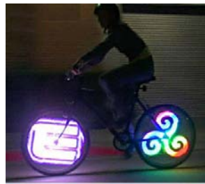
Fig. 2. Aplicación donde se usa la rueda giratoria de la bicicleta, basada en un banco de leds que van cambiando de color según la velocidad angular de giro.
