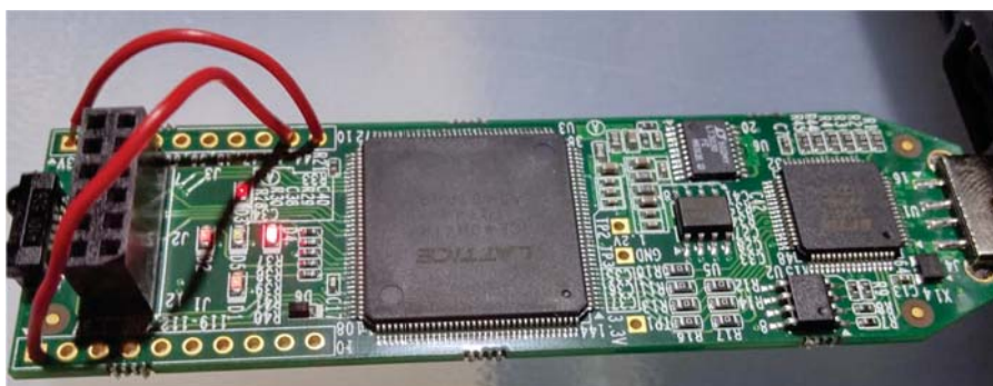
Figura 8. Tarjeta FPGA para aprendizaje Lattice ICEstick iCE40HX1K.
