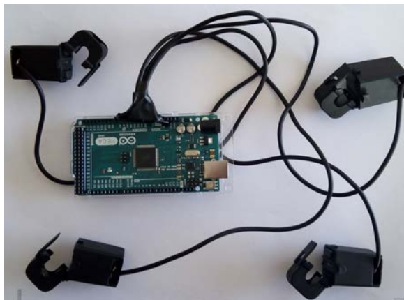
Figura 3. Placa basada en Arduino Mega y sensores de corriente
