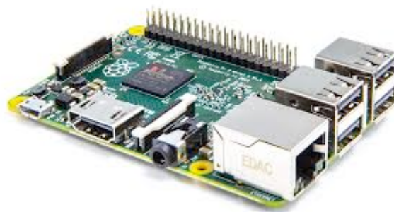
Figura 3. Raspberry Pi 2 que se utiliza como puente entre los dos maletines
