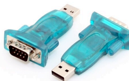
Figura4b. Dos adaptadores a 9pin-USB para conectar los cables de la figura 4a a través de la UART de los maletines a la Raspberry.
